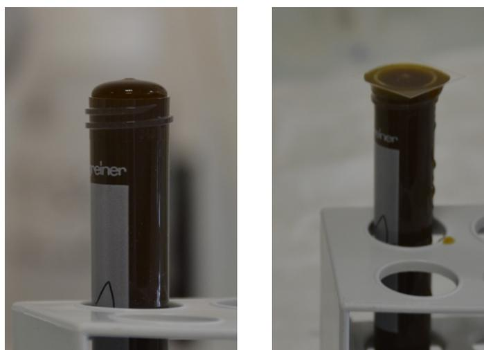
A : tube rempli à ras-bord jusqu'à formation d'un ménisque bombant
